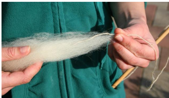
Abb. 8: Der Anfangsfaden wird in den Wollvorrat gelegt
